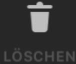
Mit diesem Button könnt ihr einzelne Inhalte löschen. Dafür drückt ihr den zu löschenden Inhalt an und anschließend auf den „LÖSCHEN“ Button.
